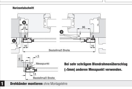
Position des Drehrahmens und des oberen Drehbandes am Blendrahmen nach den angegebenen Maßen ausmessen und markieren. Drehbandteil an Markierung positionieren, mit Bohrer  $\emptyset$  2,0 mm vorbohren und mit Montageschrauben SK 3,5x16 anschrauben.
