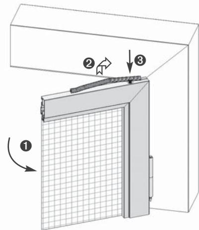
Drehstabführungshalter **4** nach den angegebenen Maßen positionieren. Für die Senkkopfschrauben SK 4,0 x 40 dem Untergrund entsprechend vorbohren und Drehstabführungshalter anschrauben.
