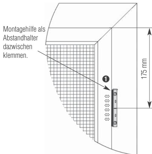
**1** Montagehilfe als Abstandhalter zwischen Magnetschließer-Grundkörper und Drehrahmen klemmen. Die Magnete aus dem Grundkörper und Drehrahmen fangen sich. Mitte Magnetschließer-Grundkörper 175 mm von Außenkante Drehrahmen positionieren.
