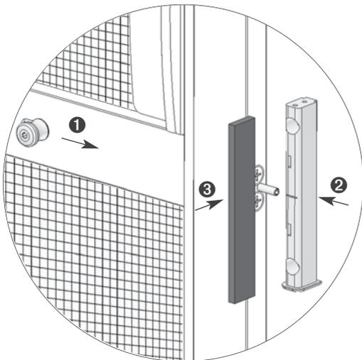
Schieberiegelstift positionieren **1** (ausfahren). Schiebeverschluss Grundkörper auf den Schieberiegel stecken **2** und Montagehilfe als Abstandhalter dazwischen klemmen **3**.
