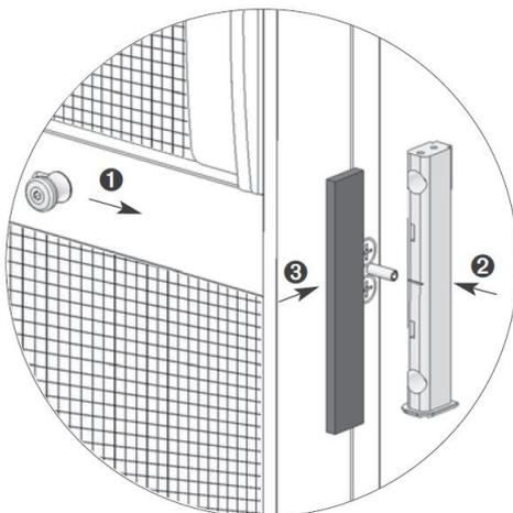
Schieberiegelstift positionieren ① (ausfahren). Schiebeverschlussgrundkörper auf den Schieberiegel stecken ② und Montagehilfe als Abstandhalter dazwischen klemmen ③.
