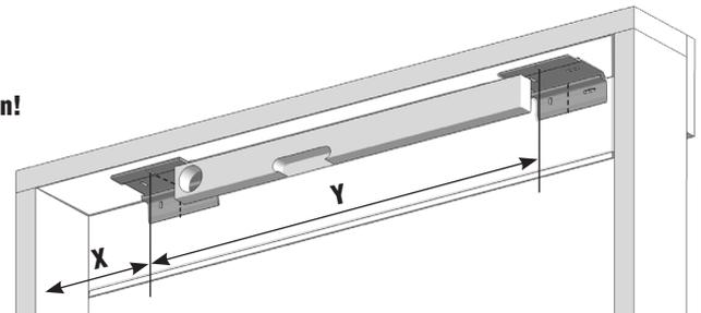
❹ **Für Befestigung der Montageplatten (Decke oder Wand), immer zwei Schrauben pro Montageplatte benutzen! Auf Schraubenkopf-Höhe achten: max 3mm!**
