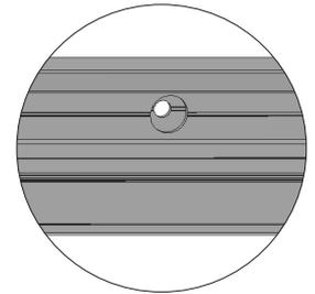
❸ Mit Bohrer  $\varnothing$  4,5 mm die seitlichen Führungsschienen nach den angegebenen Maßen von innen an der Bohrrille durchbohren. Danach mit dem Kegelsenker  $\varnothing$  9,8 mm die erste Profilwand durchsenken.
