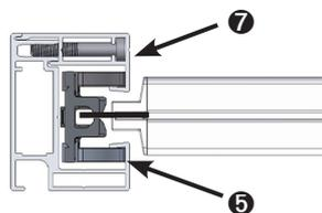
❻ Dabei darauf achten, dass die hinteren Clips in der vorderen Nut des Grundprofils einklippen ❺ und mit einer freien Auszangung im Höhenfixierungsteil hängt ❻.
