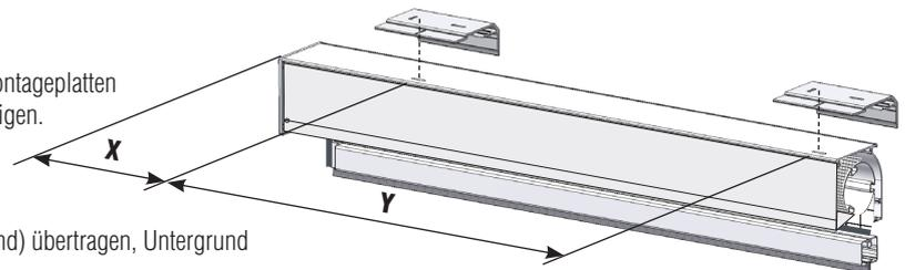
Die entnommenen Maße an das Mauerwerk (Decke oder Wand) übertragen, Untergrund entsprechend vorbohren und bei Bedarf Dübel setzen.
