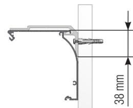
❺ **Bei Wandmontage, Abstand von Oberkante Bestellmaß Höhe bis Unterkante Montageplatte = 38 mm.**
