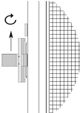
In der Höhe ausgerichteter Drehrahmen, seitlich gegen den Anschlag fahren (2) und durch festes Andrücken der Montagelehre an den Blendrahmen (3) die Bohrpositionen markieren. Vorbohren und die Drehbandteile mit Montageschrauben SK 3,5x16 anschrauben.
