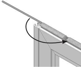
Drehen Sie die Feder gegen den Uhrzeigersinn soweit bis die Feder hinter dem Anschlagteil eingehängt werden kann.
