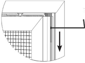
Mit dem mitgeliefertem Inbusschlüssel oberes Drehbeschlag lösen und aus Buchse schieben.
