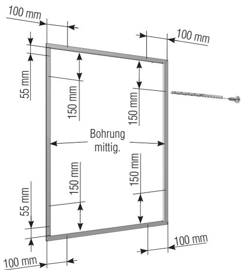
Montagerahmenprofile nach den angegebenen Maßen (**Achtung: Blockmagnet in Stulpprofil!**) mit Bohrer  $\varnothing 4,0$  mm von vorne durchbohren und mit Kegelsenker  $\varnothing 9,8$  mm 17 02 10.09 die erste Profilwand durchsenken. Ab einer Höhe von 1800 mm 4 Bohrungen. Breitenabhängig eventuell zusätzliche Bohrung oben mittig.
