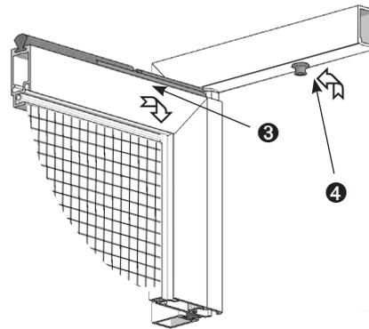
Den Abstand des Drehrahmens zum Montagerahmen prüfen ob dieser rundum gleich ist (6 mm), bei Bedarf die Position des Montagerahmens korrigieren.
