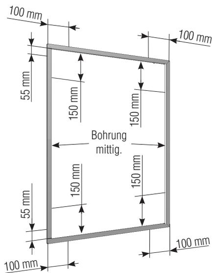
Montagerahmenprofile nach den angegebenen Maßen (**Achtung: Blockmagnet in Stulpprofil!**) mit Bohrer  $\varnothing$  4,0 mm, von innen nach außen, vorbohren. Die innere Profilwand mit dem Zapfensenker 17 34 10 ansenken. Ab einer Höhe von 1800 mm 4 Bohrungen. Breitenabhängig eventuell zusätzliche Bohrung oben mittig.
