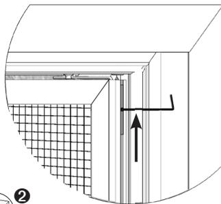
Oberen Drehbeschlag mit Drehmomentschraubendreher mit 1,7 Nm anziehen.
