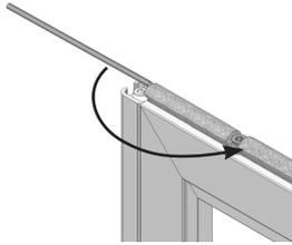
Drehen Sie die Feder gegen den Uhrzeigersinn soweit bis die Feder hinter dem Anschlagteil eingehängt werden kann.
