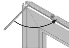
(1) Drehrahmen wie abgebildet mit dem unteren Drehbeschlag in das Aufnahmeteil stecken, zum Montagerahmen ausrichten. (2) Oberen Drehbeschlag mit dem mitgelieferten Inbusschlüssel auf Anschlag in Buchse einschieben und fest anziehen.
