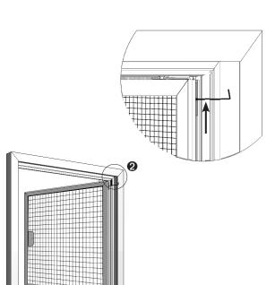
(♠)Drehrahmen wie abgebildet mit dem unteren Drehbeschlag in das Aufnahmeteil stecken, zum Montagerahmen ausrichten. (♠) Oberen Drehbeschlag mit dem mitgelieferten Inbusschlüssel auf Anschlag in Buchse einschieben und fest anziehen.
