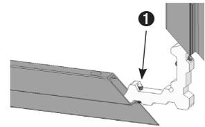
**! Rechtwinklig orientierte Schraube ! in den waagrechten Profilen (da Bohrungen für Kunststoffbuchsen)!**
