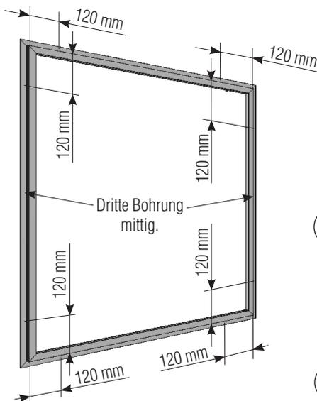
Die Fahne der Montagerahmenprofile nach den angegebenen Maßen mit Bohrer  $\varnothing 4,0$  mm von vorne durchbohren. Breitenabhängig eventuell zusätzliche Bohrung oben mittig. Ab einer Höhe von 1600 mm mind. 4 Bohrungen. Anschließend mit dem Kegelsenker  $\varnothing 8$  mm ansenken. Von hinten die Bohrungen entgraten.
