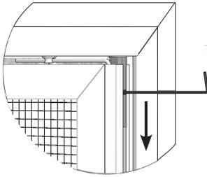
Mit dem mitgeliefertem Inbusschlüssel oberes Drehbeschlag lösen und aus Buchse schieben.
