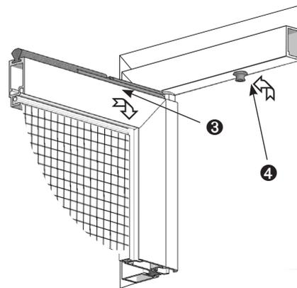
Den Abstand des Drehrahmens zum Montagerahmen prüfen ob dieser rundum gleich ist (6 mm), bei Bedarf die Position des Montagerahmens korrigieren.
