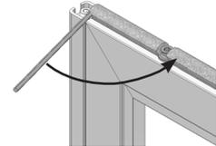
(1) Drehrahmen wie abgebildet mit dem unteren Drehbeschlag in das Aufnahme-teil stecken, zum Montagerahmen ausrichten. (2) Oberen Drehbeschlag mit dem mitgelieferten Inbusschlüssel auf Anschlag in Buchse einschieben und fest anziehen.
