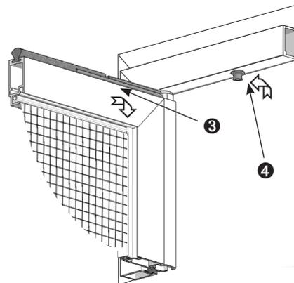
Den Abstand des Drehrahmens zum Montagerahmen prüfen ob dieser rundum gleich ist (6 mm), bei Bedarf die Position des Montagerahmens korrigieren. Schraubenköpfe mit Abdeckklebescheiben abkleben.
