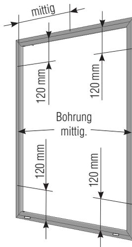
Die Fahne der Montagerahmenprofile, oben mittig und seitlich nach den angegebenen Maßen mit Bohrer  $\varnothing 4,0$  mm von vorne durchbohren. Ab einer Höhe von 1600 mm mind. 4 Bohrungen. Anschließend mit dem Kegelsenker  $\varnothing 8$  mm ansenken. Von hinten die Bohrungen entgraten.
