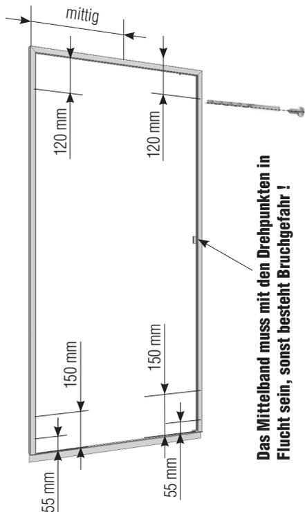
Montagerahmen oben mittig und seitlich mit Bohrer  $\varnothing 4,0$  mm nach den angegebenen Maßen (**Achtung: Blockmagnet in Rahmenprofil!**) vorbohren und mit Kegelsenker  $\varnothing 9,8$  mm 17 02 11.10 die erste Profilwand durchsenken. In der Höhe mind. 4 Bohrungen.
