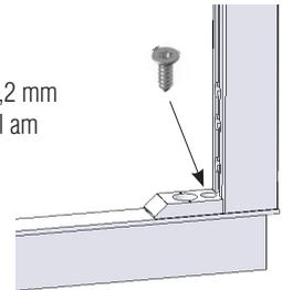
Montagerahmenprofile oben mittig und seitlich nach den angegebenen Maßen (**Achtung: Blockmagnet in Rahmenprofil!**) mit Bohrer  $\varnothing 4,0$  mm, von innen nach außen, vorbohren. Die innere Profilwand mit dem Zapfenanker 17 34 10 ansenken. In der Höhe mind. 4 Bohrungen.
