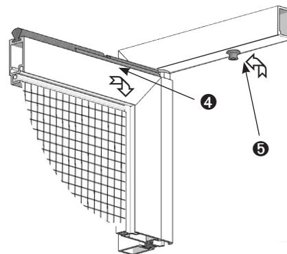
Den Abstand des Drehrahmens zum Montagerahmen prüfen ob dieser rundum gleich ist (6 mm), bei Bedarf die Position des Montagerahmens korrigieren. Sichtbare Schraubenköpfe mit Abdeckklebescheiben abkleben.
