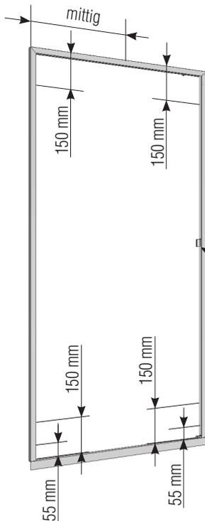
Befestigungsschrauben am Winkelprofil leicht hemmend lösen. Montagerahmen vor dem Blendrahmen positionieren und Winkelprofil zum Blendrahmen (Trittlech) anpassen. Befestigungsschrauben wieder anziehen.
