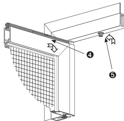
Den Abstand des Drehrahmens zum Montagerahmen prüfen ob dieser rundum gleich ist (6 mm), bei Bedarf die Position des Montagerahmens korrigieren. Sichtbare Schraubenköpfe mit Abdeckklebescheiben abkleben.
