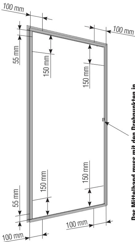
Das Mittelband muss mit den Drehpunkten in Flucht sein, sonst besteht Bruchgefahr!
