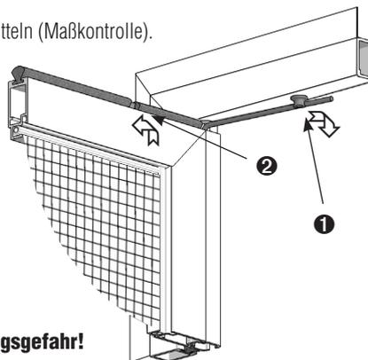
**! Die Feder steht unter Spannung! Verletzungsgefahr!**
