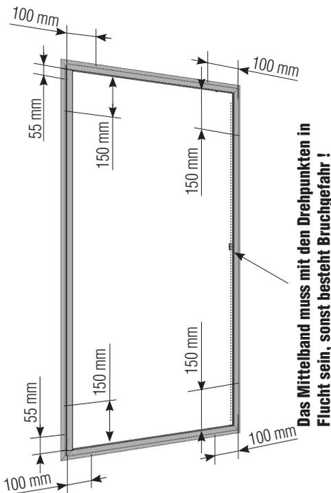
Die Fahne der Montagerahmenprofile nach den angegebenen Maßen, mit Bohrer  $\varnothing 4,0$  mm von vorne durchbohren. In der Höhe mind. 4 Bohrungen. Breitenabhängig eventuell zusätzliche Bohrung mittig in den waagerechten Profilen. Anschließend mit dem Kegelsenker  $\varnothing 8$  mm ansenken. Von hinten die Bohrungen entgraten.
