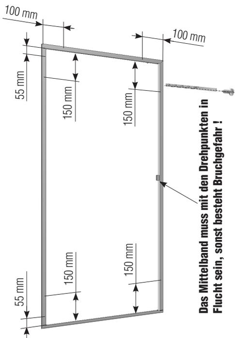
Das Mittelband muss mit den Drehpunkten in Flucht sein, sonst besteht Bruchgefahr!
