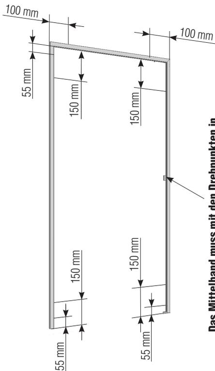
**Das Mittelband muss mit den Drehpunkten in Flucht sein, sonst besteht Bruchgefahr!**
