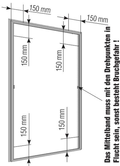
**Das Mittelband muss mit den Drehpunkten in Flucht sein, sonst besteht Bruchgefahr!**
