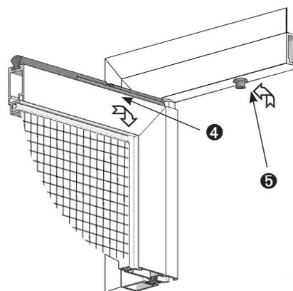
Den Abstand des Drehrahmens zum Montagerahmen prüfen ob dieser rundum gleich ist (6 mm), bei Bedarf die Position des Montagerahmens korrigieren. Sichtbare Schraubenköpfe mit Abdeckklebscheiben abkleben.
