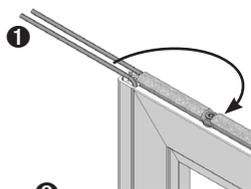
Drehen Sie die linke Feder **1** im Uhrzeigersinn über die rechte Feder soweit bis die Feder hinter dem Anschlagteil eingehängt werden kann.
