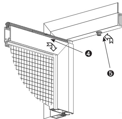
Den Abstand des Drehrahmens zum Montagerahmen prüfen ob dieser rundum gleich ist (6 mm), bei Bedarf die Position des Montagerahmens korrigieren. Sichtbare Schraubenköpfe mit Abdeckklebescheiben abkleben.
