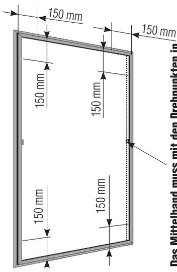
**Das Mittelband muss mit den Drehpunkten in Flucht sein, sonst besteht Bruchgefahr!**
