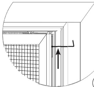
**1**) Drehrahmen wie abgebildet mit dem unteren Drehbeschlag in das Aufnahme-teil stecken, **2**) zum Mittelband ausrichten, Schiebeklemmteile mit dem mitgelieferten Inbusschlüssel in das Mittelband schieben und anziehen. **3**) Oberen Drehbeschlag mit dem mitgelieferten Inbusschlüssel auf Anschlag in Buchse einschieben und fest anziehen.
