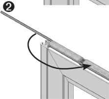
Drehen Sie nun die rechte Feder **2** gegen den Uhrzeigersinn über die linke Feder soweit bis die Feder hinter dem Anschlagteil eingehängt werden kann.
