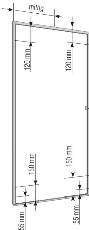
Das Mittelband muss mit den Drehpunkten in Flucht sein, sonst besteht Bruchgefahr!
