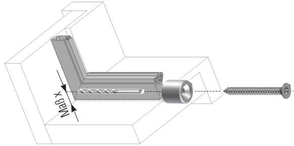
Mit Bohrer  $\varnothing$  2,5 mm an den Markierungen vorbohren und Auflagerundteile mit SK 4,0 x 40 anschrauben.
