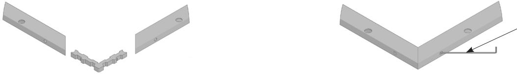
Profile mit den Schraubeckwinkeln zu einem Rahmen zusammenstecken. Mit dem 2,0 mm Inbusschlüssel abwechselnd links und rechts verklemmen.
