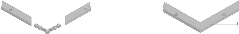
Obere und seitliche Laufschieneprofile mit den Schraubewinkeln zu einem U-Rahmen zusammenstecken. Mit dem 2,0 mm Inbusschlüssel abwechselnd links und rechts verklemmen.
