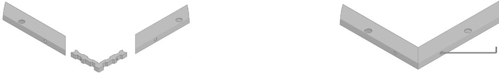
Obere und seitliche Laufschieneprofile mit den Schraubewinkeln zu einem U-Rahmen zusammenstecken. Mit dem 2,0 mm Inbusschlüssel abwechselnd links und rechts verklemmen.
