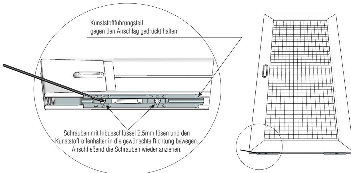
👍 In Gewindestift eingesteckter Inbusschlüssel zeigt die aktuelle Höhenposition der Laufrolle.
