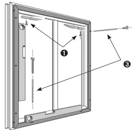
Schiebeflügel einhängen (siehe **4**) und schließen. Mitgeliefertes Stulprofil zum Schiebeflügel ausrichten und Außenkante am Blendrahmen markieren. Schiebeflügel aushängen. Durch die Montagebohrungen des Stulprofils vorbohren und mit SK 3,9x38 anschrauben. Senkschraubenköpfe mit den Abdeckklebscheiben abkleben.
