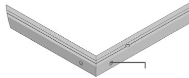
Laufschieneprofile mit den Schraubeckwinkeln zu einem Rahmen zusammenstecken. Mit dem 2,5 mm Inbusschlüssel abwechselnd links und rechts verklemmen.
