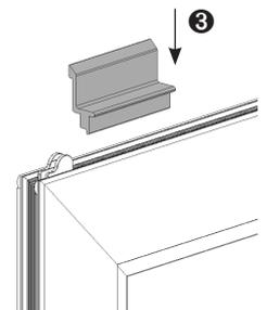
5 Oberkante Laufschiene nach den Markierungen ausrichten. Durch die Montagebohrungen vorbohren und mit RK 3,5x13 anschrauben.
