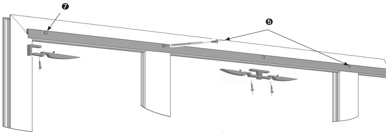
6 Bohrlehre 164851/50 an der Markierungen der Außenkante (Punkt 2) ansetzen. Durch die beide äußeren Bohrbuchsen mit Bohrer  $\varnothing$  2,2 mm vorbohren. Danach Mittelanschlagspunkt für beide Laufschiene festlegen. Mit der gleichen Bohrlehre im Abstand von je 6 mm links und rechts vom Mittelanschlagspunkt, durch die beide äußeren Bohrbuchsen vorbohren. Anschlagwinkel und Schiebeflügelarretierungen mit LK 2,9x16 anschrauben.
