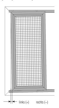
Durch Verschieben des Kunststoffrollenhalters in die (-) Richtung, wandert der **Schiebeflügel** auf dieser Seite um **1 mm** nach **unten**.
