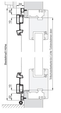
**Laufschienen Montagebohrungen** (falls mitbestellt, weiter mit Schritt **2**)
