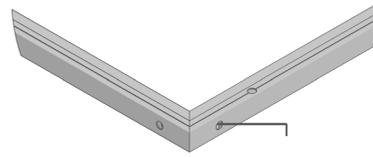
Obere und seitliche Laufschieneprofile mit den Schraubeckwinkeln zu einem U-Rahmen zusammenstecken. Mit dem 2,0 mm Inbusschlüssel abwechselnd links und rechts verklemmen.
