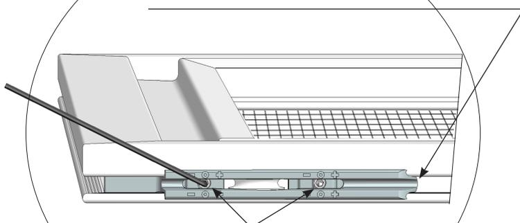
Schrauben mit Inbusschlüssel 2,5mm lösen und den Kunststoffrollenhalter in die gewünschte Richtung bewegen. Anschließend die Schrauben wieder anziehen.
