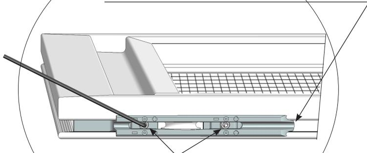
Schrauben mit Inbusschlüssel 2,5mm lösen und den Kunststoffrollenhalter in die gewünschte Richtung bewegen. Anschließend die Schrauben wieder anziehen.
